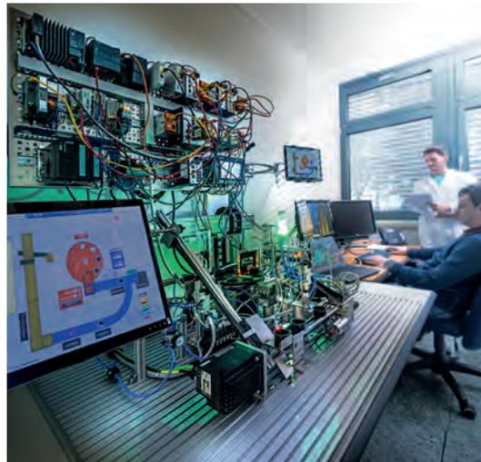
Abb. 2: Das IT-Sicherheitslabor bietet eine gesicherte Umgebung, um Schwachstellen in modernen Produktionsanlagen ausfindig zu machen und mögliche Angriffsszenarien durchzuspielen.
